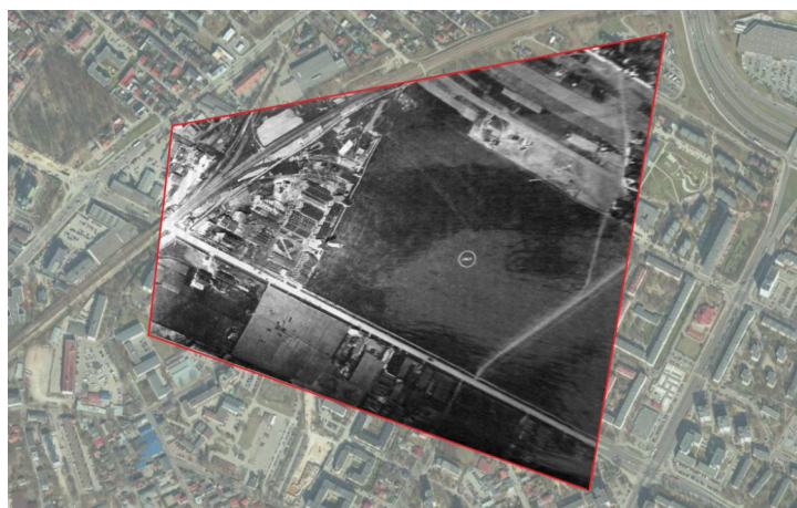
Fot. 5b. Zdjęcie po kalibracji. Nieregularny, trapezowaty obszar zasięgu zdjęcia jest spowodowany dużym nachyleniem kamery w trakcie wykonania zdjęcia.
