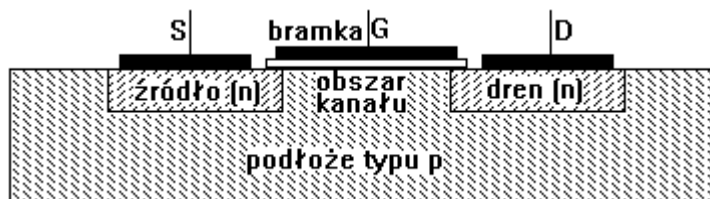
Rys. 6. Budowa tranzystora MOSFET.
